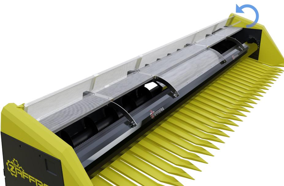
Жатка для подсолнечника Заффрани снабжена центральной фиксированной сетью и двумя боковыми сетями, предназначенными для защиты механических устройств. Боковые сети можно регулировать по высоте. Они выполняют важную функцию защиты оператора и удержания продукта в пределах зоны транспортировки, от конвейерного ролика до канала комбайна.
