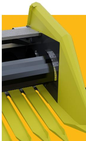
Закругленные бока и фигурные картеры позволяют комбайну без затруднений продвигаться по полю, в том числе в направлении, противоположном направлению посева, со скоростью до 12 км/ч.
